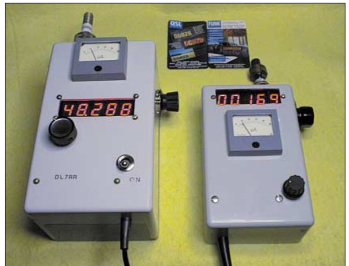
Einbau des 45-MHz-Zählers in vorhandene Geräte Foto: DL7RR
