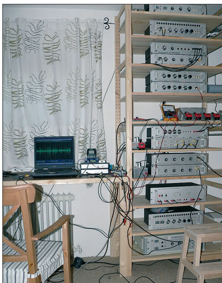
Bild 5: Nicht nur zur Ausgabe zusätzlicher Empfangssignale, auch für die Durchführung speziellerer Messungen eignen sich verschiedene Komponenten meiner Sferics-Empfangsanlage mit den entsprechenden Folgegeräten.
