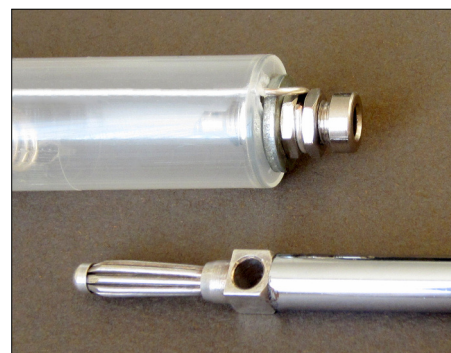
Bild 5: Hier ermöglichen eine Telefonbuchse und ein Bananenstecker den steckbaren Anschluss des Strahlers Foto: DG8FK
