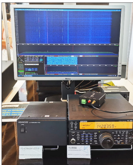
Auch der TS-590SG bietet im Zusammenwirken mit SDRplay RSP2 eine komfortable Wasserfalldarstellung des gesamten Bandes.
