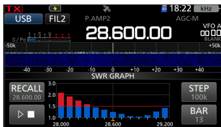
Bild E2: SWV-Plot-Anzeige, hier auf dem 10-m-Band an einer Multibandantenne 807-L
