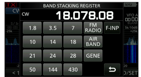
Bild E6: Tippen auf die Megahertz-Stellen fuhrt zum Bandstapel-Register
