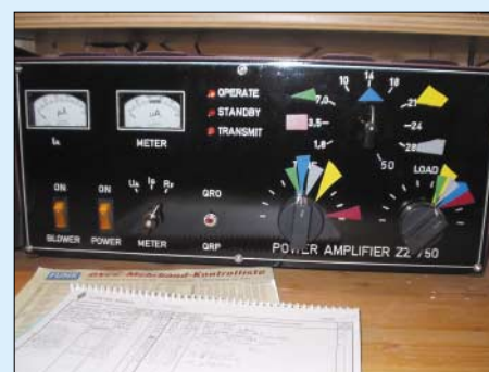
UY5ZZ-PA – die von mir angebrachten farbigen Aufkleber erleichtern die Abstimmung auf den verschiedenen Bändern.
