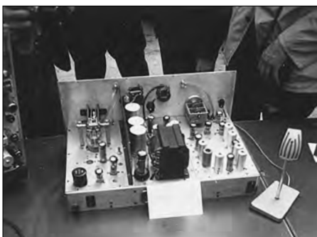
2-m-Station von DM3YN, geöffnet; TX quartzgesteuert, RX abstimmbare
