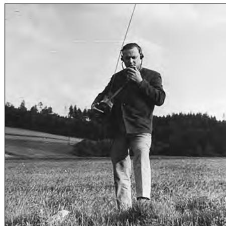
Hans Ullrich, DG2VRL, ex DM3YZL, unter- wegs mit dem für 2 m umgebauten Klein- funksprecher „Dorette“
