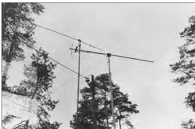
Antennen der Tagungsstation; 2 m: 9-Element-Yagi nach OK1DE, 70 cm: 14-Element- Yagi
