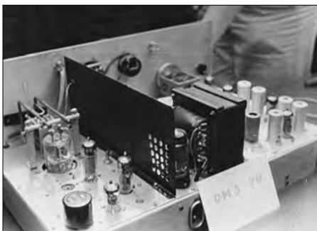
2-m-Station von DM3YN, geöffnet; TX quartzgesteuert, RX abstimmbare – die damals gängige Betriebsweise
