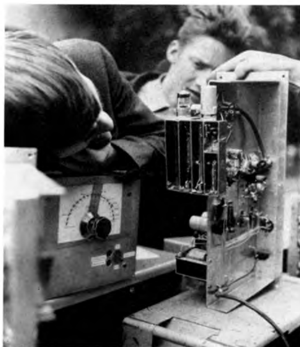
Interessiert wird der 70-cm-Konverter von Eike, DM 3 ML/DM 2 BUL betrachtet. Ähnlich aufgebaut wie ein UHF-Tuner ist das Eingangsteil mit 2 \times EC 86 . Auf dem Hauptchassis ist der Oszillatorteil aufgebaut, der eine Frequenz von 20,5 MHz erzeugt, die zur Mischung auf 403 MHz verdoppelt wird (Bild oben)
