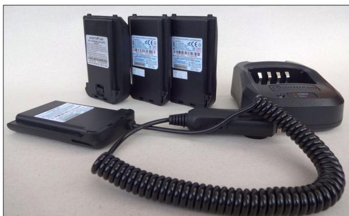
Zur Stromversorgung gibt es zwei verschiedene Akkupacks, einen Batteriekasten für fünf Mignonzellen oder einen Adapter mit Spannungswandler sowie eine Ladeschale für die Akkupacks.
