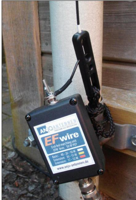
**Bild 7:** Befestigung des Übertragergehäuses in unmittelbarer Nähe Endisolators am Antennenfußpunkt
