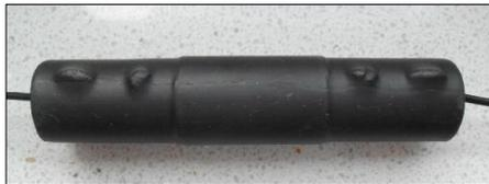
**Bild 6:** Im Schrumpfschlauch ist die Verlängerungsspule vor Witterungseinflüssen geschützt.
