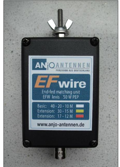
**Bild 8:** Kunststoffgehäuse mit 1:49-Unun-Ringkernübertrager; die Farbmarkierungen für Basisversion des Strahlers und der Erweiterungen sind auf dem Gehäuse vermerkt.
