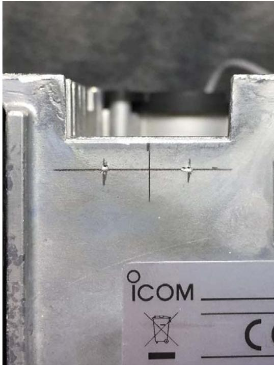
IC-7300 vorbereitet zum Bohren.
