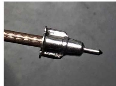
Spitze sauber verlöten und die beiden «Flügel» am Stecker mit der Flachzange verpressen. Überstehende Abschirmung abschneiden.
