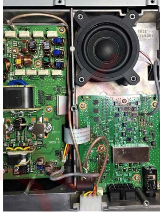
Links das Kabelrouting wie es im Original war. Rechts eine Alternative welche das RG-316 Kabel weniger knickt. Das RG-316 ist steifer als die von Icom verwendeten Kabel.
