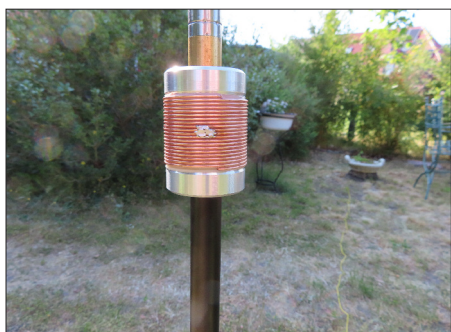
Bild A2: Die für den Betrieb der MC-750 auf dem 30-m-Band modifizierte, zweite Verlängerungsspule besitzt Zoll-Gewinde und passt somit ebenfalls zwischen Antennenfußrohr und Teleskopstrahler.
