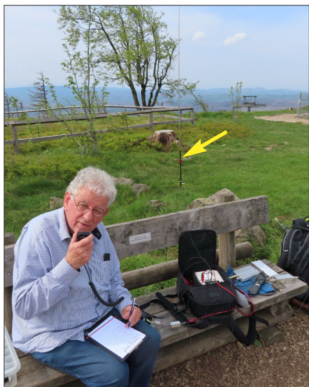
Bild A1: DK5RK beim Test auf dem Wurmberg (DM/NS-001) im Harz mit der MC-750 im Hintergrund; Equipment auf der Bank (v.l.n.r.): unter dem linken Unterarm Icom IC-705, im Rucksack 15-Ah-LiFePo 4 -Akkumulator, 45-W-Linearendstufe, 100-W-Bandfilter für 20 m. Letzteres erlaubte den gleichzeitigen Betrieb einer zweiten Station auf 40 m. Foto: H.-G. Wuorner
