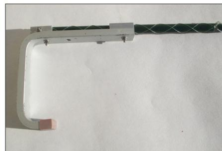
Bild A6: Halterung mit eingeklapptem Tragearm
