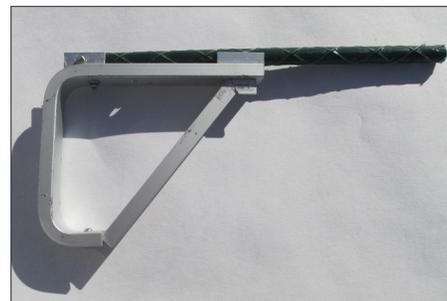
Bild A7: Halterung mit zusätzlichem Profilstück zur Verstärkung
