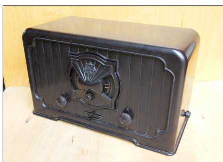
Bild 4: Der „Katzenkopf“ 340W aus dem Jahre 1931 darf natürlich nicht fehlen, wenn Telefunken in dieser 6. Ausstellung ein Schwerpunkt ist. Er besitzt drei Kreise und vier Röhren.
