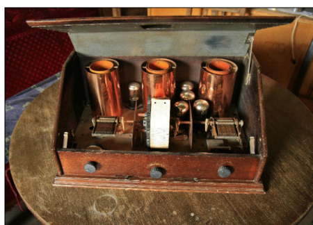
Bild 2: Der T 9 von Telefunken 1927, ein Pultradio mit Trommelskala und fünf Röhren; die Pappskala ist unbeschriftet. Man wird aufgefordert, die gefundenen Sender selbst in die Linien einzutragen.
