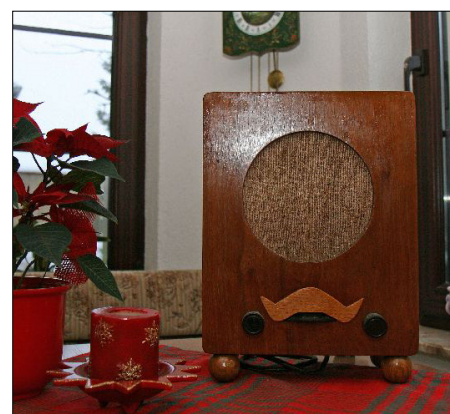
Bild 5: Auffällig das „Schnurrbart“-Notradio von 1946, das als „Eingeweide“ den DKE 38 besitzt, aber jetzt mit der UCL 11 und einem Selengleichrichter daherkommt. Der Freischwinger ist für den Außenwiderstand verschiedener Lautsprecherröhren anpassbar.
