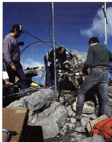
Aus Glasfibrerstäben und Planen wird ein unwetterfestes Stationszelt aufgebaut.
