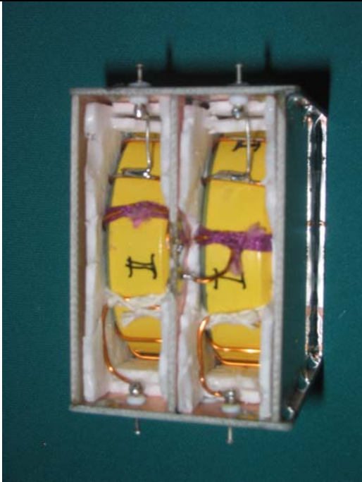
Abbildung 7: Beide T200 – Schwingkreispulen mit Styroporbeilagern eingebaut. Gehäuse verlötet (ohne Bodenplatte)
