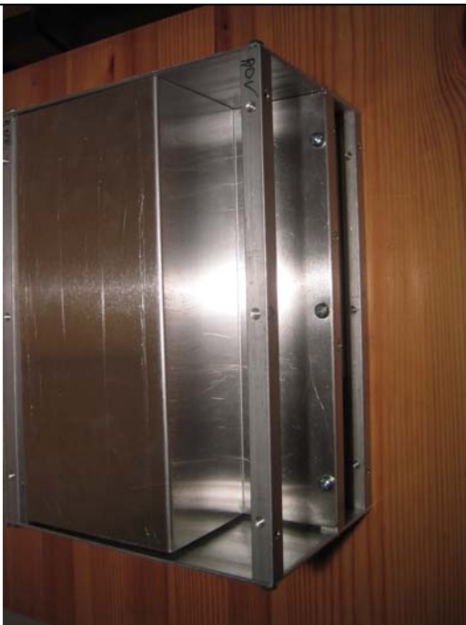
Abbildung 15: Filter von der Schwingkreisseite aus gesehen mit Abschirmblech im Gehäuse
