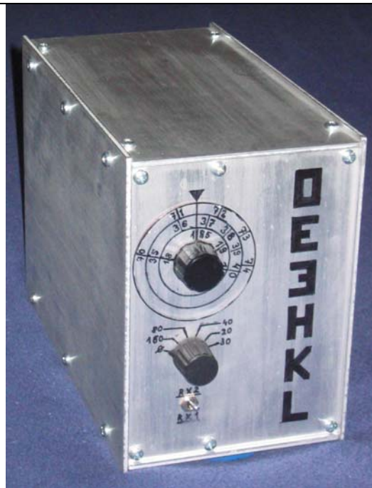
Abbildung 16: Preselektor im Gehäuse – Gesamtansicht
