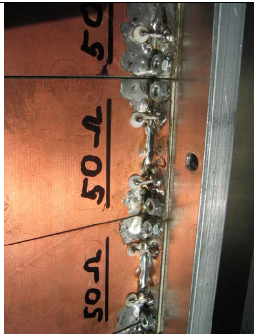
Abbildung 10: Filter von 50 Ohm IN – OUT Seite aus gesehen – Teflon Koaxialkabel von unten, durch die Bodenplatte heraufgeführt, und beidseitig als Durchkontaktierung verlötet
