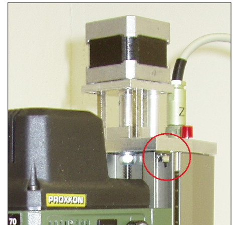
Montage des Endschalters -Y und des An- schlagwinkels
