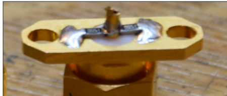
Bild E1: Selbst gebauter 75-Ω-Abschlusswiderstand für den Funktionstest
