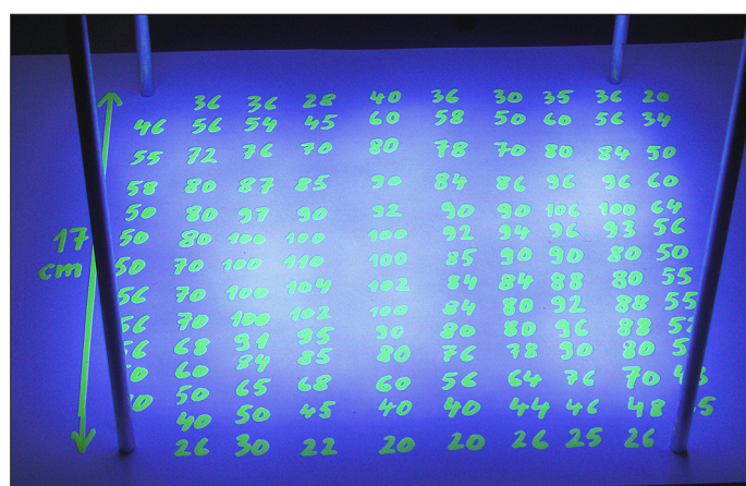
Bild A1: Messwerte der UV-Intensitat auf der beleuchteten Flache, relativ zur Mitte
