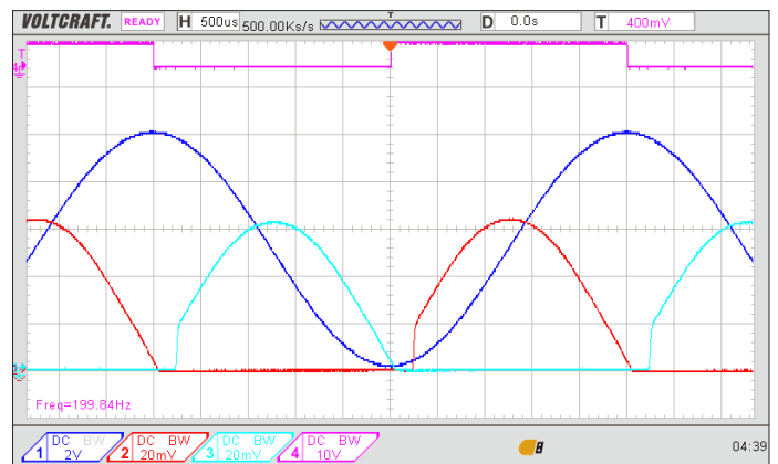
Bild A2: Verhalten bei kapazitiver Last; es fließen Ströme zur Last und zurück.
