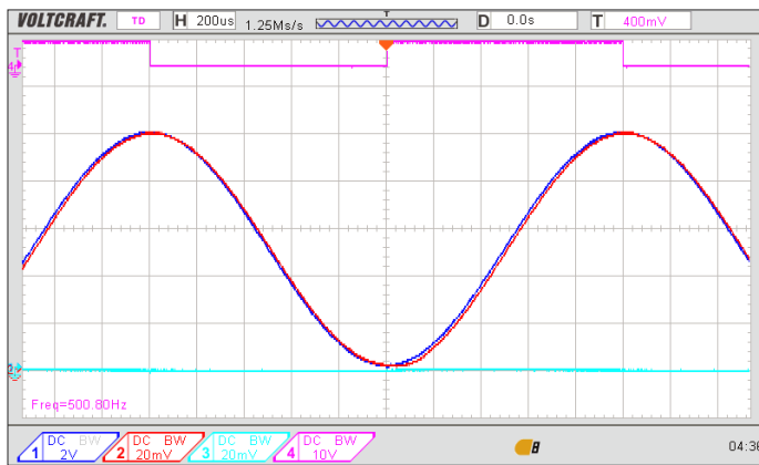
Bild A2: Verhalten bei kapazitiver Last; es fließen Ströme zur Last und zurück.
