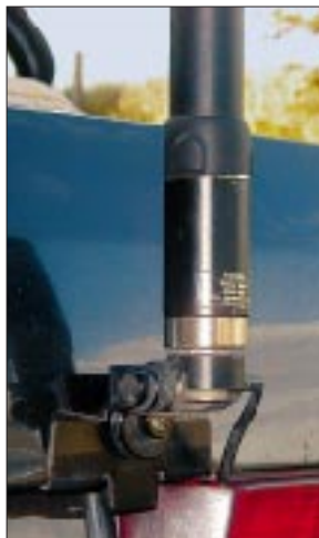
Die Montage mit der Diamond Typ K400 oder ähnlichen eher für CB-Antennen bestimmten Halterungen erscheint angesichts der etwa 1000 g des ATAS-100 und der nicht beliebig stabilen Karosserie eines Pkw doch etwas problematisch.
