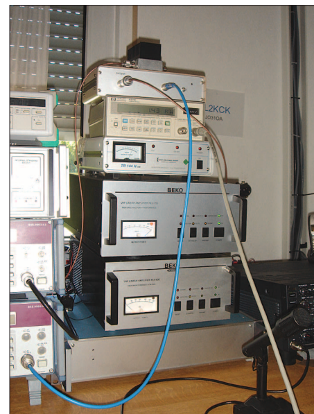
Bild 10: Eindruck vom Testaufbau; links unten Signalgeneratoren, ganz oben Wilkinson-Teiler; die untere kleine PA diente lediglich zu Vergleichszwecken. Foto : DL2KCK
