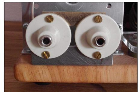
**Bild 6:** Symmetrischer Antennenausgang mit Telefonbuchsen
