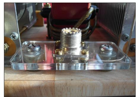
**Bild 8:** Die SO-239 Buchse lässt sich auf einem Acrylglaträger in horizontaler Montage direkt auf dem Holzbrett befestigen.
