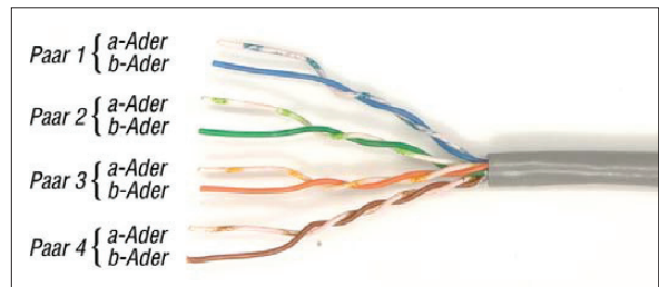
Bild 6: Netzwerkkabel nach EIA/TIA-568B
