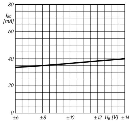
Bild 4: Ruhestromaufnahme als Funktion der Betriebsspannung
