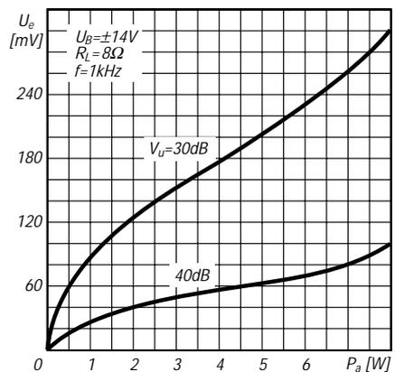
Bild 8: Signal-Eingangsspannung und Ausgangsleistung an 8 Ω
