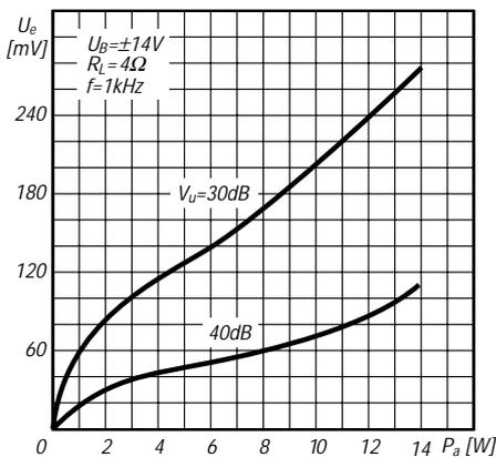
Bild 7: Signal-Eingangsspannung und Ausgangsleistung an 4 Ω
