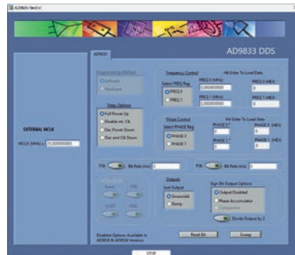
Bild 8: Bedienoberfläche der auf www.analog.com/en/products/ad9833.html verfügbaren AD9833 Evaluation Software (Rev. B), mit der sich das Evaluation-Board steuern lässt
