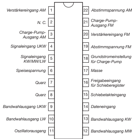
Bild 4: Pinbelegung des 22poligen DIL-Gehäuses
