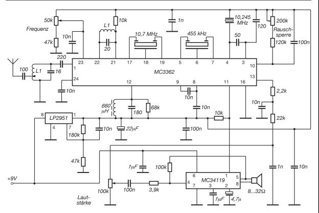
Bild 5: Schaltung eines 2-m-Amateurempfängers. Der MC 3362 wurde dazu um einen Spannungsregler für 5 V und einen Audio-Endverstärker ergänzt.
