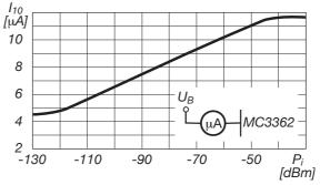
Bild 3: Interne Pegel in Abhängigkeit von der Eingangsleistung
