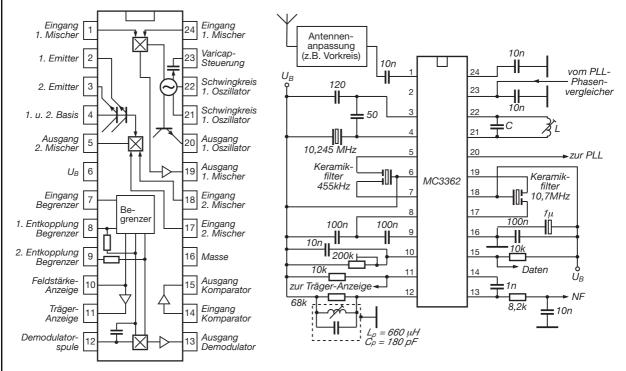
Bild 1: Interner Blockaufbau und Anschlußbezeichnungen
