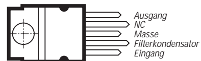
Bild 1: Pinbelegung (Kühlfläche mit Masse verbunden); Wärmewiderstand zwischen Kühlfläche und Sperrschicht max. 4 K/W
