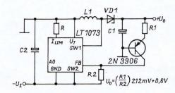
Bild 10: Negativ-zu-positiv-Konverter
