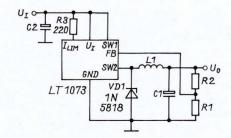
Bild 8: Beschaltung für Step-Down-Mode
