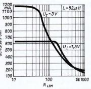
Bild 6: Maximaler Schaltstrom als Funktion des Widerstands zwischen Pin 1 und 2
