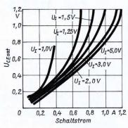
Bild 4: Sättigungsspannung in Abhängigkeit vom Schaltstrom (Step-Up)
