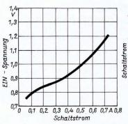
Bild 5: EIN-Spannung als Funktion des Schaltstroms (Step-Down)
