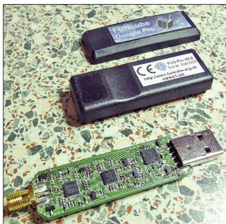
**Bild 1:** Der FCD besteht aus einer Leiterplatte, die sämtliche Bauelemente trägt, sowie aus einem zweiteiligen Kunststoffgehäuse. Die Leiterplatte ist beidseitig bestückt. Der HF-Anschluss (SMA-Buchse) ist auf der einen Seite montiert und der USB-Anschluss (Typ A) auf der gegenüberliegenden Seite. Die Abmessungen des komplett montierten Geräts, einschließlich der HF- und USB-Anschlüsse, betragen etwa 86 mm x 23 mm x 14 mm. Foto: DL2LUX
