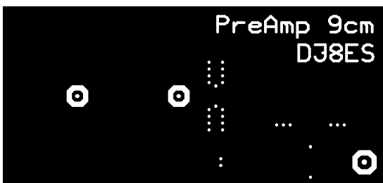
Layout der Platine 1-stufiger Verstärker, Oberseite, 72 mm x 34 mm, M1:1
