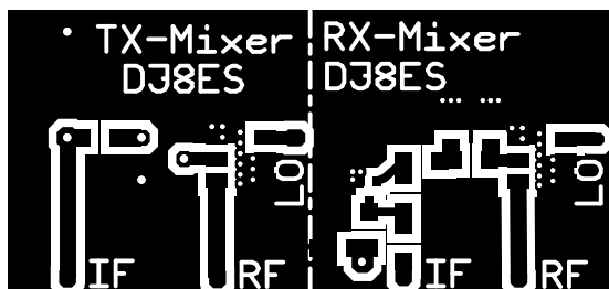
Layout der gemeinsamen Platine TX-Mischer und RX-Mischer, Oberseite, 72 mm × 34 mm, M1:1; Platine muss geteilt werden.
