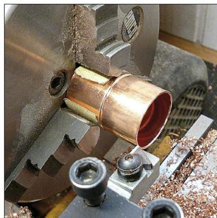
**Bild AH 4:** Ein Streifen dickeres Papier zwischen dem Kupferrohr und dem Drehbankfutter verhindert Quetschmarken.
