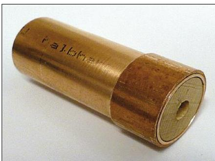
**Bild AH 1:** Ein Kern (hier aus Holz) und ein Stück einer Muffe stabilisieren das Kupferrohr an der Einspannstelle im Drehbankfutter.
