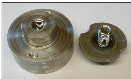
**Bild AS 3:** Dorn zur Aufnahme der Scheiben auf der Drehbank
