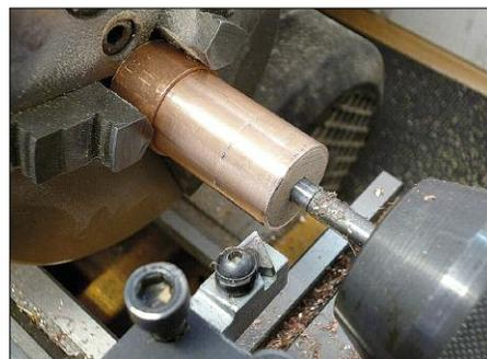
**Bild AH 2:** Ein Dorn im Bohrfutter des Reitstocks stabilisiert das Kupferrohr zusätzlich.
