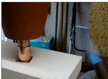
Bild AH 6: Verlöten des Verstärkungsrohrs und der Abschlussplatte
