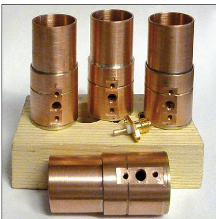
Bild AH 9: Fertige Hornstrahler, noch ohne SMA-Buchse und SMA-Buchse mit aufgelötetem Koppelstift
