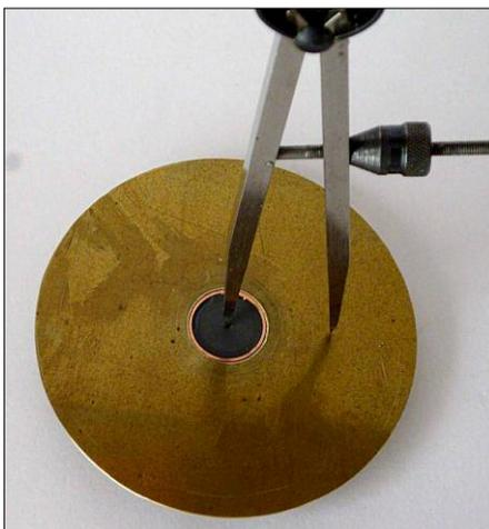
**Bild AS 5:** Bohrungen für SMA-Buchse und Abstimmerschrauben anreißend und ankörnend
