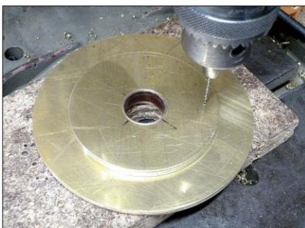
**Bild AS 6:** Strahler- und Reflektorscheibe(n) übereinander legen und mit 22-mm-Rohrstück zentrieren, 1,4-mm-Bohrung für SMA-Stift einbringen
