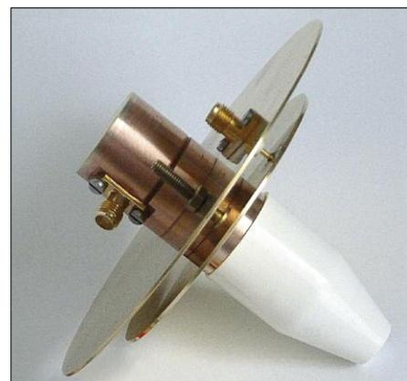
Bild DA 2: Der fertige Duoband-Feed mit aufgesetztem dielektrischen Konzentrator
