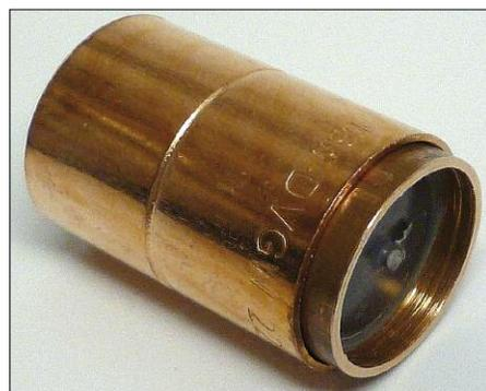
**Bild AH 3:** Ein Kern verstärkt die Kupfermuffe an der Einspannstelle.
