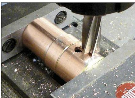
Bild AH 8: Planfräsen der Fläche für die SMA-Buchse
