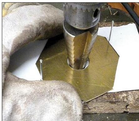
**Bild AS 2:** Bohren der 22-mm-Löcher mit dem Stufenbohrer, Öl zugeben!
