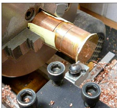
Bild AH 7: Abdrehen der Abschlussplatte; umspannen und Anschlag für Reflektorplatte bündig drehen
