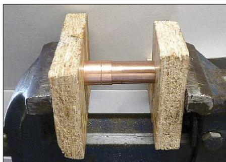
Bild AH 5: Das bearbeitete Verstärkungsrohr wird auf Horn-Rohr aufgespresst.
