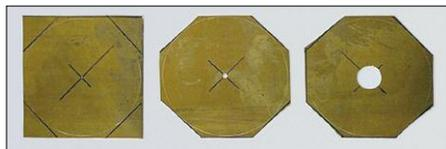
**Bild AS 1:** Platinen aus 1 mm Messingblech aussägen, Mittelpunkt anzeichnen, für Stufenbohrer vorbereiten, Ecken absägen, mit Stufenbohrer auf 22 mm aufbohren
