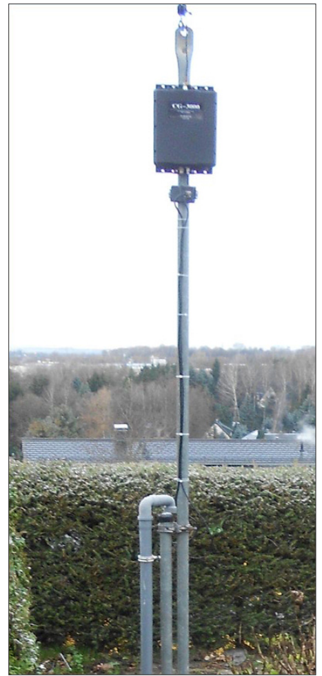
Bild 9: Installation des CG-3000 im Garten bei DM6WAN
