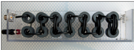
Bild A2: Seite eins des Kellermann-Baluns mit FRK-25-N30
