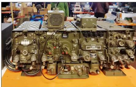
Für solche Geräte war der Autor dieses Beitrags als Funkmeister bei der BW in den 60er-Jahren zuständig: R-108, RT-68, RT70 und zugehörige Stromversorgungen. Fotos: DF5SBA
