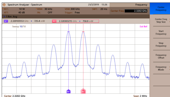
Bild E3: Aussteuerung des Senders bis auf P_A = 3 W (PEP); der IMA_3 beträgt nur noch 18 dBc.
