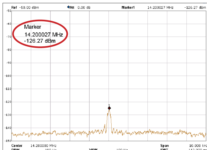
Bild E6: 0-dBm-Signal mit 126 dB Dämpfung bei f = 14,2 \text{ MHz}
