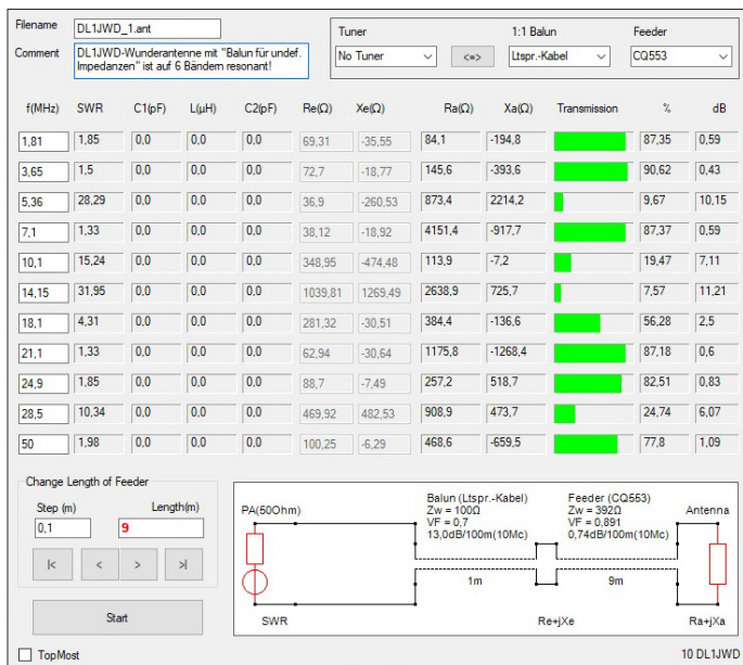
Bild 5: Mit dem Tool Multiband-OCF-Dipol lassen sich die Eingangsimpedanzen unsymmetrisch gespeister Dipole für bis zu neun Frequenzen gleichzeitig berechnen und die Stromverläufe grafisch darstellen (im Bild nicht sichtbar).
