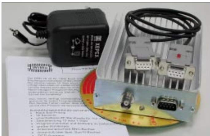
Bild 1: Gesamtansicht des PRD-70. Dank Programmierkabel sind eine leichte Installation und Inbetriebnahme gegeben.
