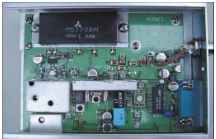
Bild 6: Blick in den Transceiver. Noch mehr SMD-Technik verbirgt sich auf der Unterseite. Oben kann zumindest der Speicherplatz ausgewählt und bei Bedarf die Sendeleistung abgeglichen werden.
