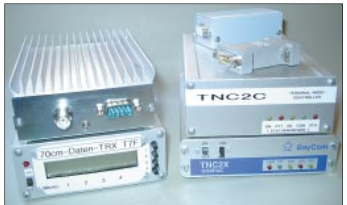
Bild 2: Das kleine Gerät spielt mit beliebigen TNCs oder Modems zusammen und eignet sich auch z.B. für SSTV im 70-cm-Band.
