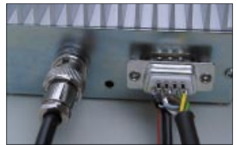
Bild 3: Mehr Anschlüsse gibt es nicht! Das Anschlusskabel für den endgültigen Betrieb darf selbst gelötet werden.
