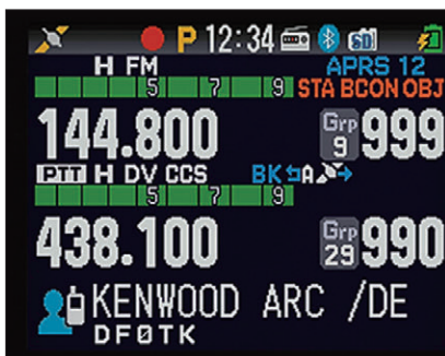
Betrieb auf 144,800 MHz als APRS-Bake
